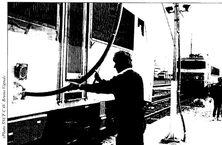
**Fig. 14 - Remplissage des sablières d'une locomotive BB 26000 par un mécanicien**
